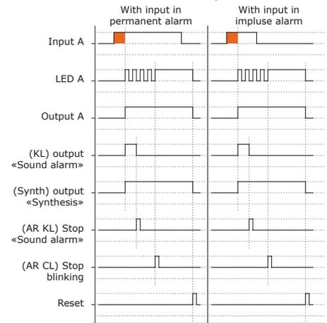
In diagram «Type 2 sequence» and «Type 3 sequence», the LEDs are represented in «fast blinking» mode.
