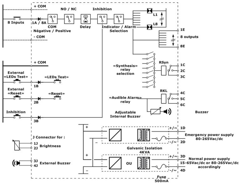
A channel can be «positive input» or «negative input».
