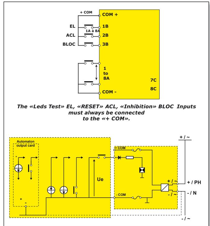
The «Leds Test» EL, «RESET» ACL, «Inhibition» BLOC Inputs must always be connected to the «+ COM».
