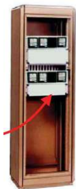
3U au standard Baie 19" Hauteur : 3U = 132mm Largeur : 484mm
