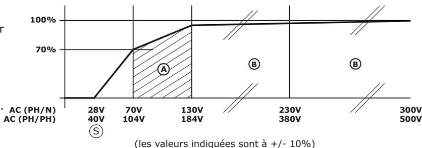
Sur le diagramme, la luminosité correcte (70%) sera atteinte à la tension minimum d'utilisation.
