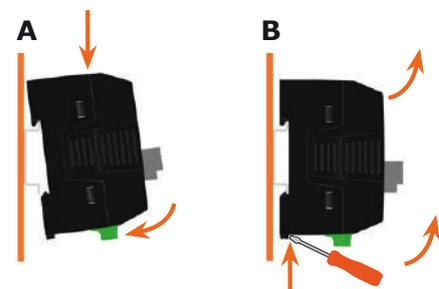
Montage (A) du boîtier sur le profilé et démontage (B)
