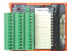
Tarjeta MO901 «relé de retorno» tipo DIN conectada al panel J1905S
