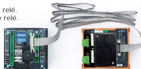
Tarjeta M0901 «relé de retorno» tipo DIN conectada al panel J1905S
