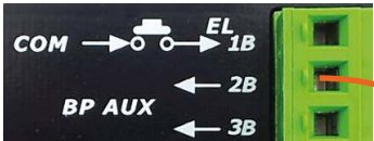
Außenseitiger Anschluss „Test-LEDs“ (EL) und Taste „AUX“ an der Frontplatte
