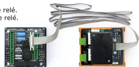
Tarjeta M0901 «relé de retorno» tipo DIN conectada al panel J1905S
