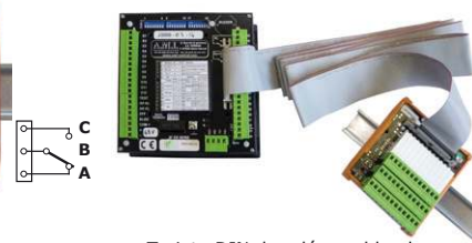
Tarjeta DIN de relé + cable plano
