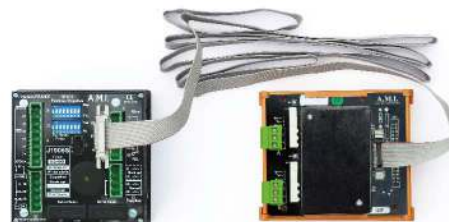
DIN-Platine M0901 „Übertragungsrelais“, angeschlossen an Tafel J1905S
