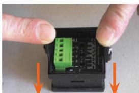
Setzen Sie den Clip zur Montage einfach auf die Anzeigetafel und drücken Sie ihn auf die Laschen.
