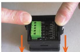
Para montar la brida de fijación, simplemente la puso en el panel y empuje las lengüetas.
