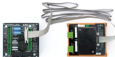
DIN-Platine M0901 „Übertragungsrelais“, angeschlossen an Tafel J1905S
